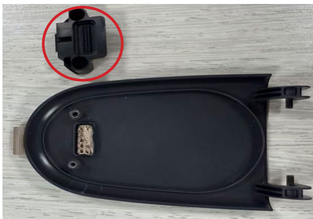
31. Retirer le capot de fixation
