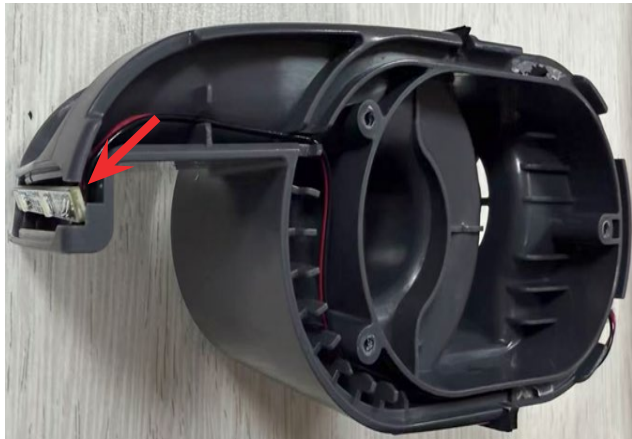
29. Retirer la carte circuit imprimé (PCB) de la lampe
