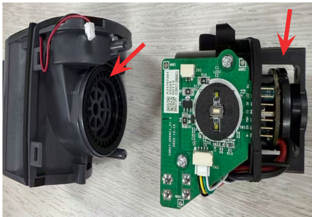
21. Retirer le support du moteur ainsi que le tampon amortisseur de la tête du moteur
