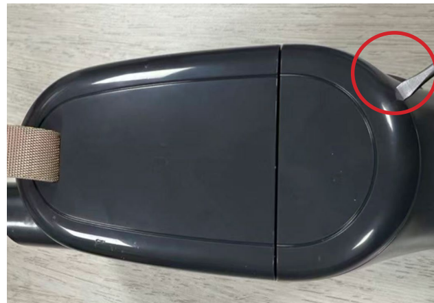
10. Retirer le capot latéral gauche à l'aide d'un tournevis à tête plate (ou de tout autre outil approprié)
