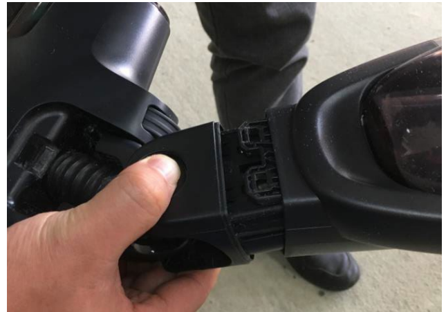
24. Retirez le couvercle droit, démontez la barre à brosse, dévissez les deux vis du couvercle gauche, puis démontez le couvercle gauche.
