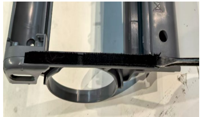
53. Relâcher le joint du connecteur inférieur
