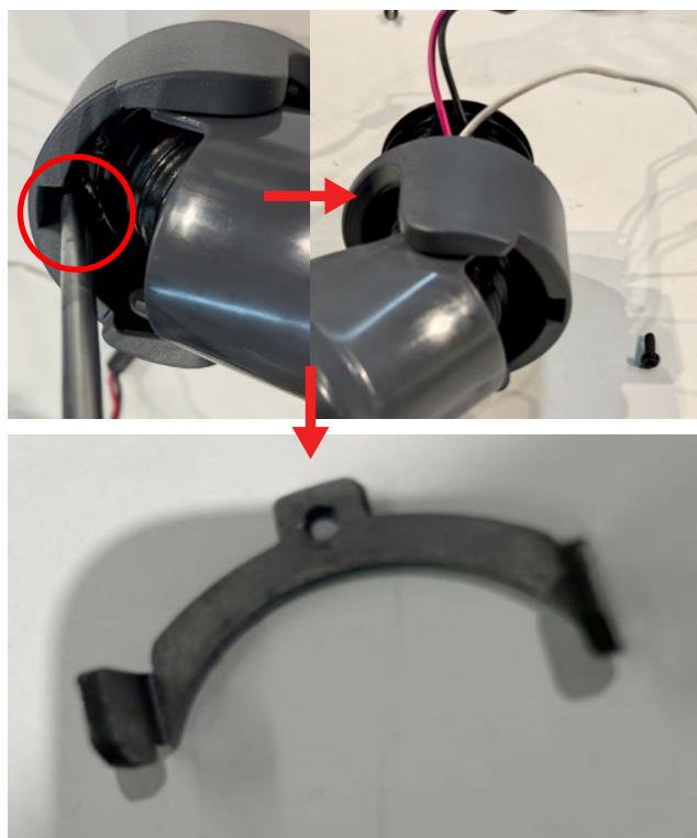
55. Enclencher les boutons-pression du connecteur inférieur, puis insérer ce dernier dans le connecteur supérieur
