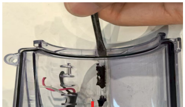
39. Retirer la bande d'étanchéité
