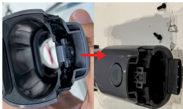
66. Appuyer sur le bouton de déverrouillage de l'embout, puis le retirer ; relâcher le connecteur supérieur situé à l'intérieur de la garniture
