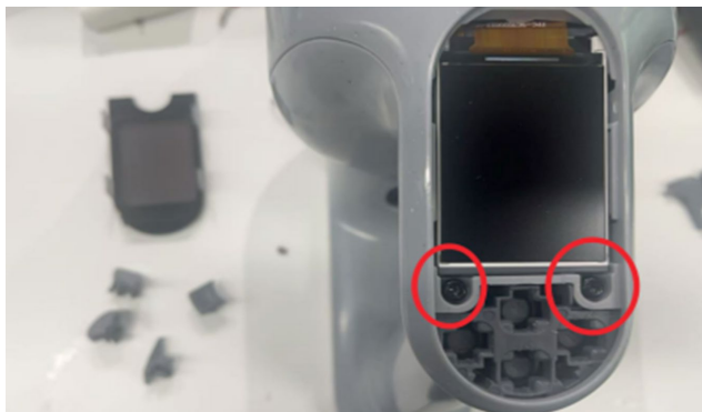
40. Relâcher le boîtier et retirer l'ensemble boîtier du moteur
