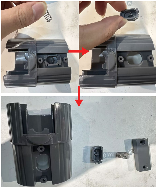
14. Débrancher le connecteur, puis le retirer
