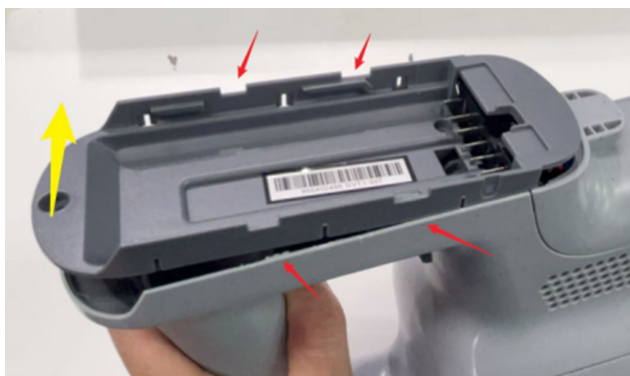
18. Tirer la partie support de batterie vers l'extérieur
