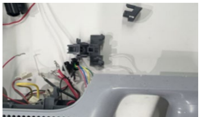
31. Retirer le tube et le support-bouton
