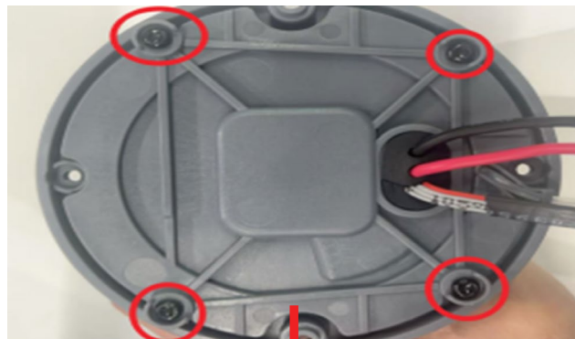
41. Retirer les quatre vis du boîtier du moteur
