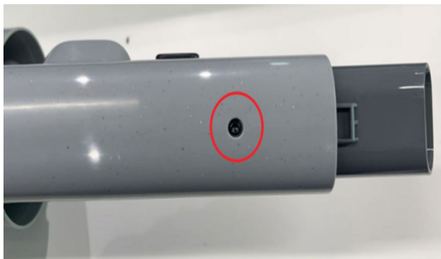
18. Tirer la partie support de batterie vers l'extérieur
