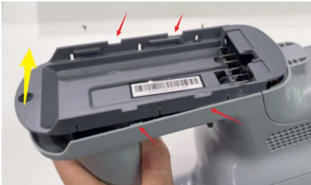
17. Tirer la partie support de batterie vers l'extérieur
